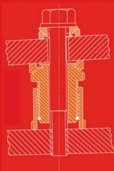
Die Kugelverstell-Schraube - KVS - ermöglicht eine Montage bei nicht parallelen Auflageflächen mit einem Neigungswinkel von bis zu 4° mit dem Vorteil des größtmöglichen Höhenverstellweges.
