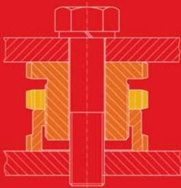
Das Niveau-Ausgleichselement mit Kontermutter - NAEK - überbrückt kleine Bauhöhen, wobei der Verstellweg  $\Delta h$  zwischen 4,0 und 14,0 mm liegt. Die Kontermutter sichert die Einstellung und eignet sich daher vor allem für Anlagen mit dynamischer Beanspruchung.
