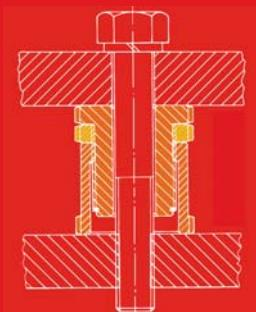
Die HVSK ist überall dort einzusetzen, wo größere Verstellwege  $\Delta h$  von 10 bis 40 mm erforderlich sind. Die Kontermutter dient zur zusätzlichen Sicherung einer vorgegebenen Einstellung.
