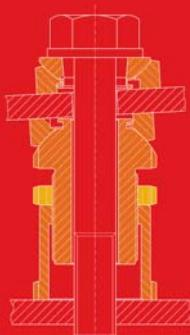
Die Kugelverstell-Schraube mit Kontermutter - KVSK - ist baugleich mit der - KVS - aber mit Kontermutter zum Sichern der gewünschten Einstellung.
